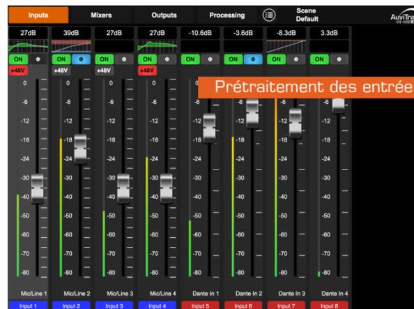
Le bloc de prétraitement des entrées gère les 2 ou 4 entrées micro/lignes ou AES et les 4 entrées Dante. Il fournit 2 ou 4 sorties directes issues des entrées AES ou micro/lignes après les préamplis analogiques et 6 ou 8 entrées prétraitées au bloc de mixage et au bloc de traitement des sorties.
